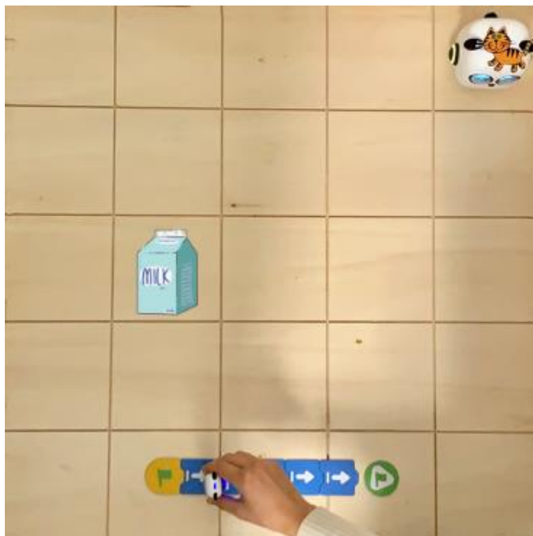
Un robot mTiny pe o grilă de lemn. Robotul este codat folosind propriile cartonașe
